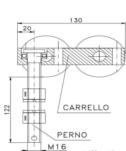
Rullino inferiore diametro 34 tipo smontabile con perno M16.Cod. R/I88B.
